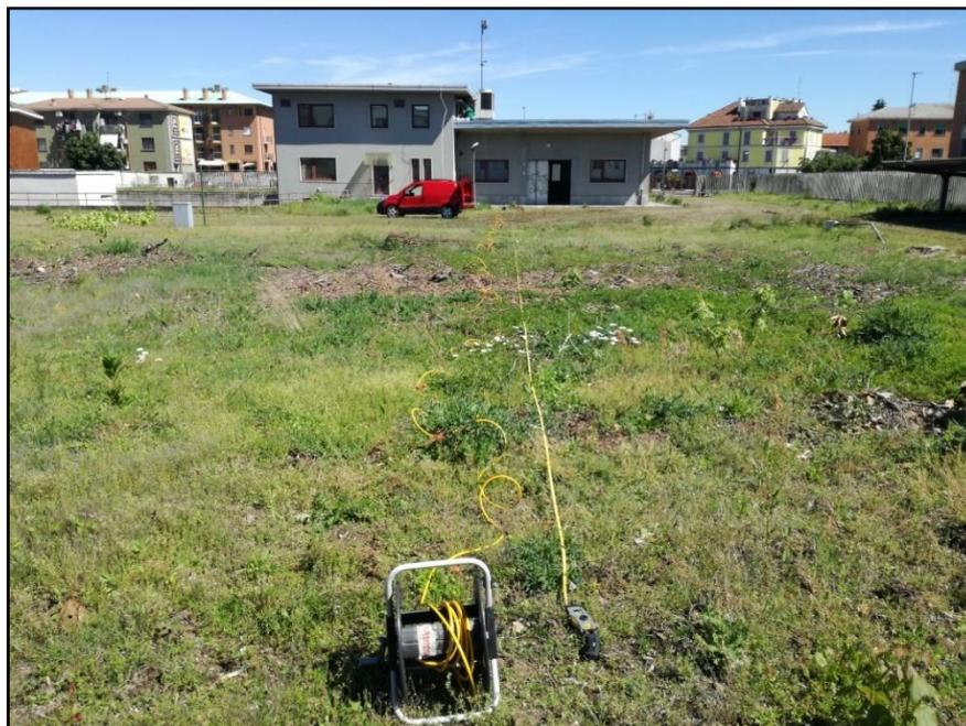
**Figura 1:** Vista dello stendimento MASW effettuato.
