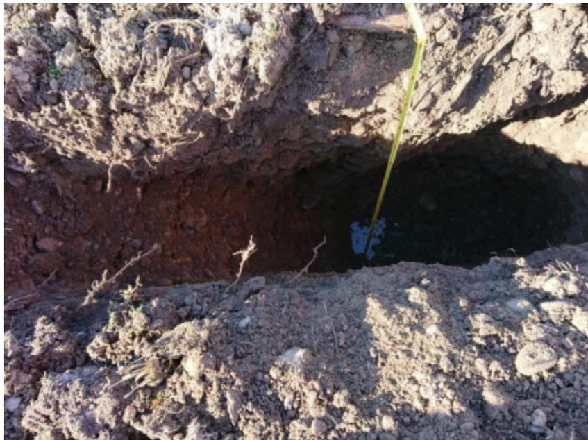
**PPD 2** quota 158.68 m slm - Quota falda -1.6 m; R = rifiuto strumentale indicato convenzionalmente con 100 colpi
